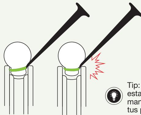
Coloca el extremo de la herramienta sobre la base del Pin tal y como aparece en el siguiente gráfico y empujalo hacia el interior de llanta hasta oír el "click".
