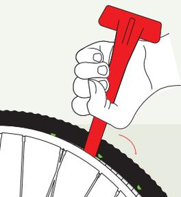
Adentrar el material de la Tannus hacia el interior de llanta facilita el talonamiento de los Pins.
