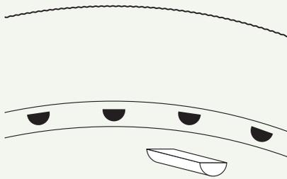
Después de Identificar la talla correcta de los Pins, inserta los Pins en los agujeros. La parte redondeada va hacia abajo, tal como indica la propia forma del agujero.
