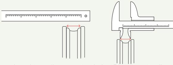
Determina el tamaño correcto de los Pins para tus llantas con un calibre o regla antes de montar tus Tannus. Generalmente, el tamaño de Pin adecuado es el que mide +3.5mm más ancho que el ancho interno de llanta.
